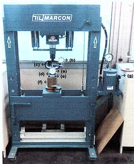
Fig. 23- Prensa hidráulica manual. (a) Medidor micrometro mecânico ligado ao disco de prensa. (b) Medidor micrometro mecânico ligado ao anel dinamométrico. (c) Anel dinamométrico. (d) Disco de prensa. (e) Corpo de prova. (f) Capa cilíndrica protetora. (g) Alavanca de aplicação de carga.
