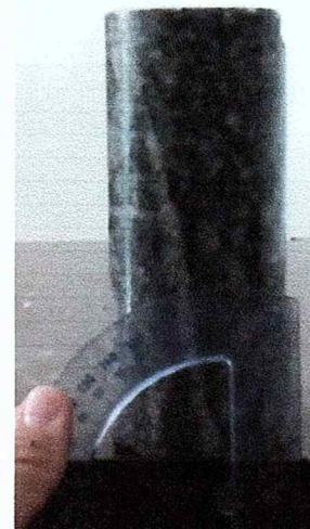
Fig. 22- Exemplo de medição do ângulo de mergulho de camada. Alinha-se o transferidor com o eixo axial, alinhando-se as marcas da base do transferidor na mesa.
