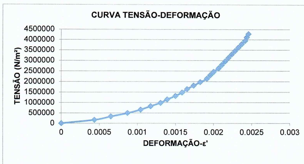
Fig. 31- Curva tensão-deformação da amostra 5 do gnaiss ultramilonítico. Atente-se para a quebra dos últimos 3 pontos.
